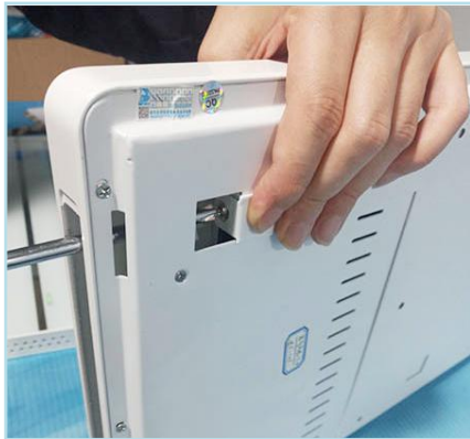
2. 将里面的螺丝拧开，取下后盖。
